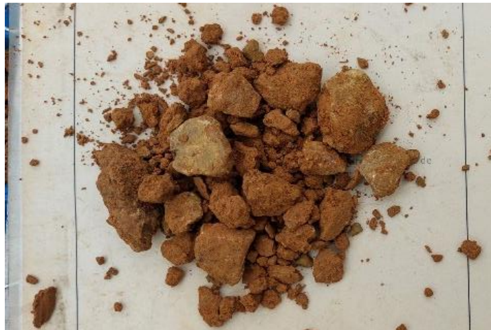
Photo 3 : PP1 - Sol de nature argilo-limoneuse à charge schisteuse
